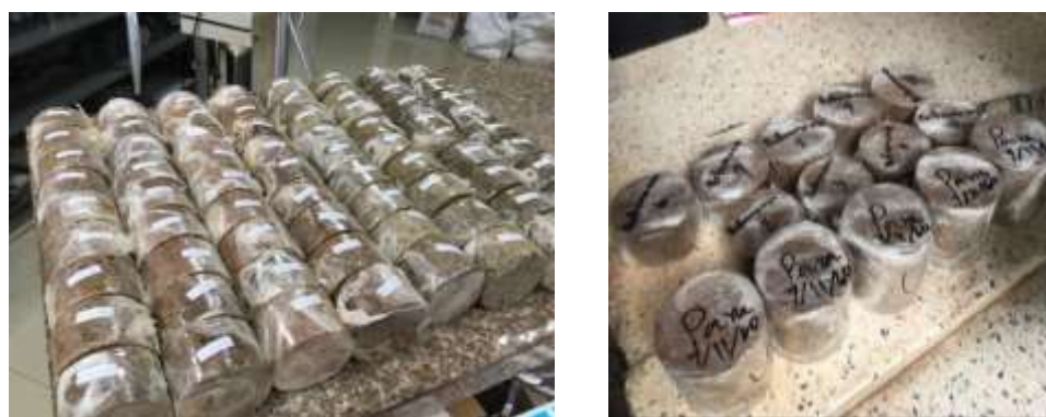
รูปที่ 5 แสดงการเตรียมก้อนตัวอย่างเพื่อนำมาทดสอบคุณสมบัติเชิงวิศวกรรมในห้องปฏิบัติการ
