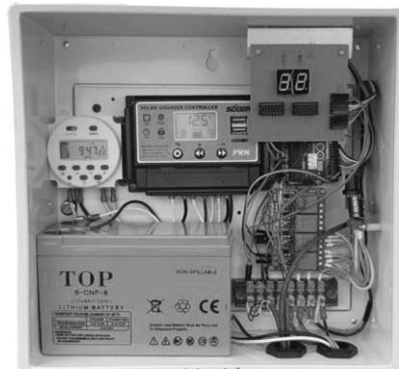
กล่องควบคุมระบบตาข่ายพรางแสงอัตโนมัติพลังงานแสงอาทิตย์
