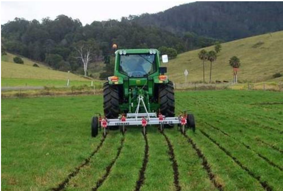
รูปที่ 20: การไถแบบคีย์ไลน์/การไถใต้ผิวดินด้วยเครื่อง Yeomans 4
