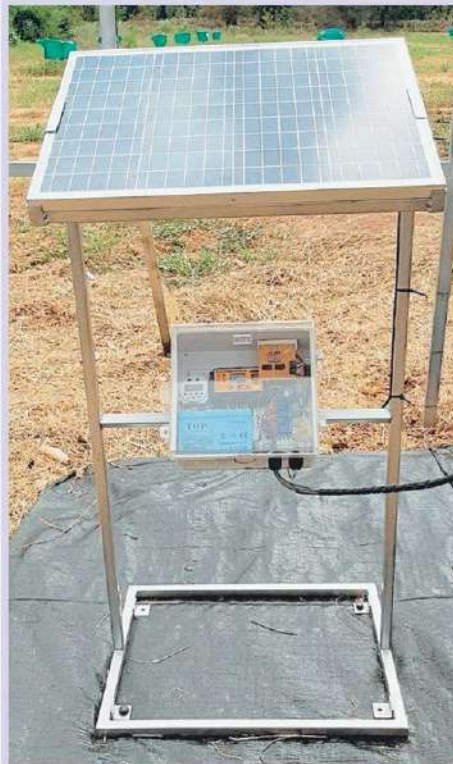
“ภายใต้หลังคาโรงเรือนได้ติดตั้งระบบควบคุมด้วยแผงพลังงานแสงอาทิตย์อัตโนมัติเพื่อลดความร้อนที่จะสัมผัส
